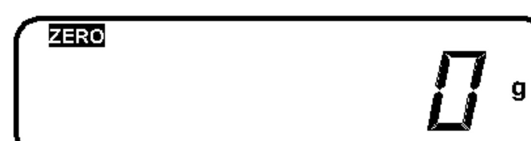
В случае дрейфа показаний по какой-либо причине при пустой платформе (при этом указатель **ZERO** выключается) нажмите клавишу **ZERO**. Нулевое показание вновь устанавливается.
